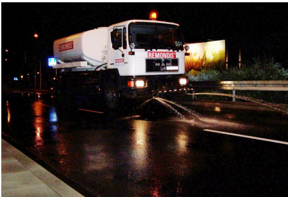
Rycina 56 Pojazd przystosowany do ciśnieniowego czyszczenia nawierzchni – przykład z Poznania
