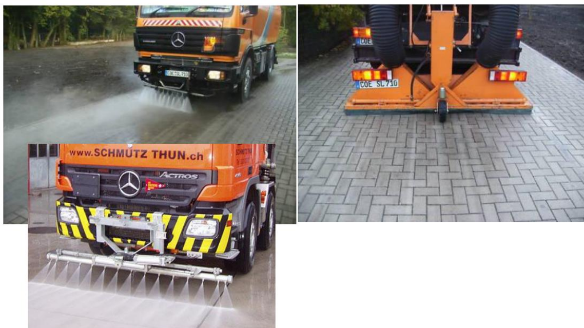
Rycina 55 Pojazd przystosowany do ciśnieniowego czyszczenia nawierzchni – przykład z Niemiec
